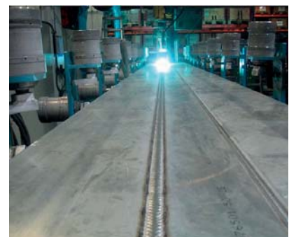
Fot. 5. Niezawodne układanie długich spoin przy użyciu drutu z opakowania Marathon Pac
