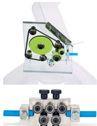
Fot. 4. Urządzenia do formowania drutów ze stopów serii 5xxx – PAK TRAK oraz zespół rolek
