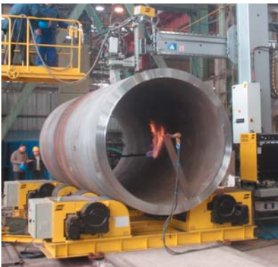
Rys.4. Widok stanowiska do spawania połączeń obwodowych pod topnikiem.
