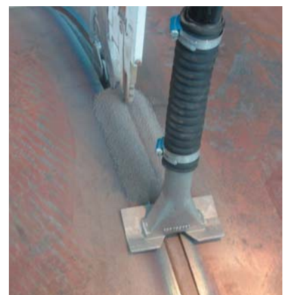
Rys.3. Złącze obwodowe płaszczka kotła wykonywane metodą spawania wąskoszczelinowego.
