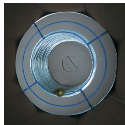
Rysunek 4. Każde opakowanie Marathon Pac wypełnione jest wysokiej jakości aluminiowym drutem spawalniczym nawiniętym specjalną techniką z przeciwskrętem, dzięki czemu drut wysuwa się z uchwytu prosty, w niezmienniej pozycji, co zapewnia większą stabilność procesu i znaczne obniżenie rozprysków. Stosowanie „gruszki” – elementu z tworzywa sztucznego gwarantuje, że drut nigdy nie zaplącze się podczas podawania.
